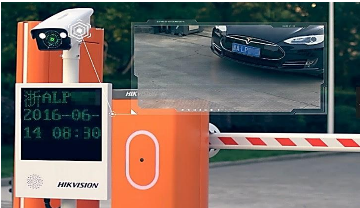
Slika 1. Automatizirani sustava kontrole pristupa parkiralištu
