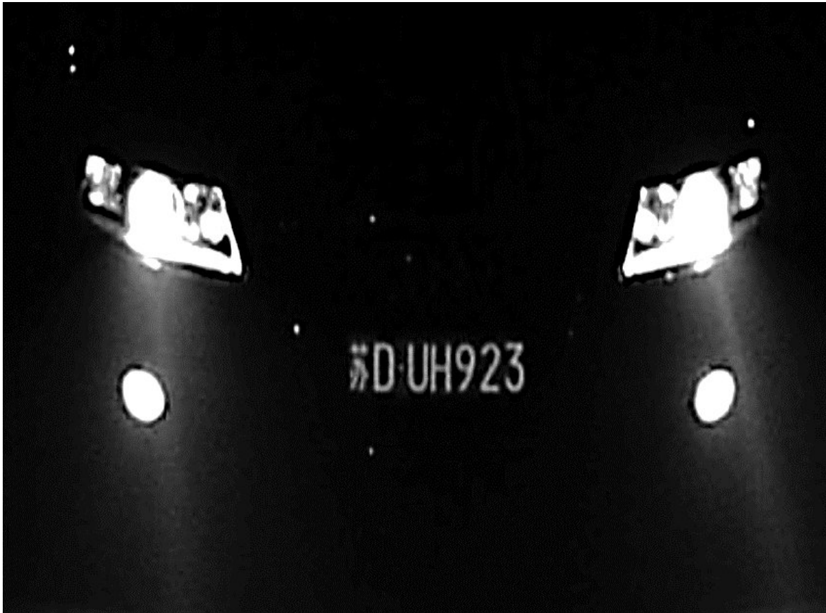
Slika 11. Snimka dobivena pomoću eclipse karakteristike ANPR kamere
