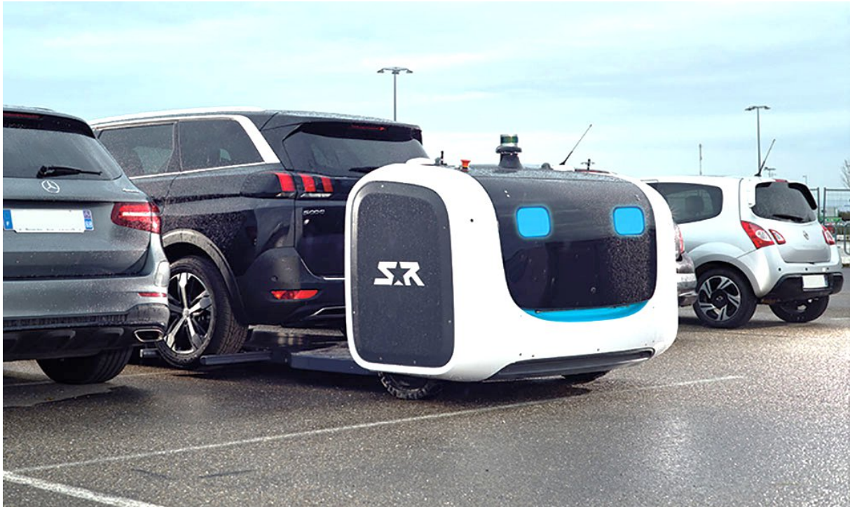
Slika 24. Prikaz parkiranja pomoću autonomnog robota
