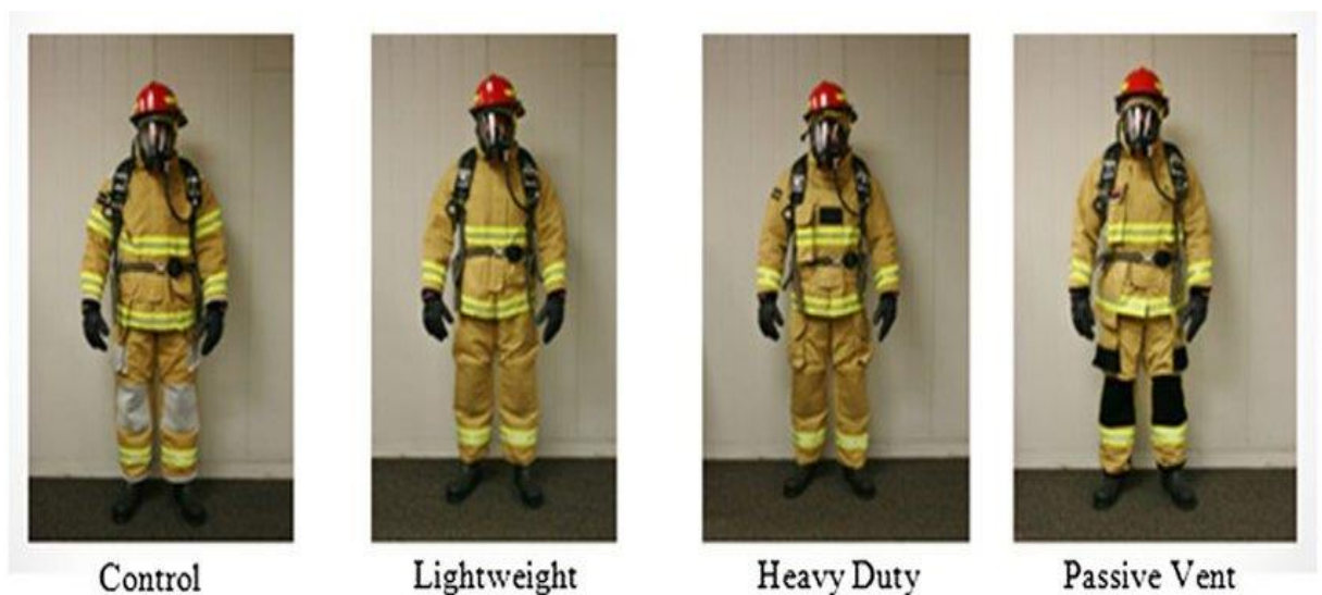
Slika 2. Zaštitno vatrogasno odijelo za strukturne požare
